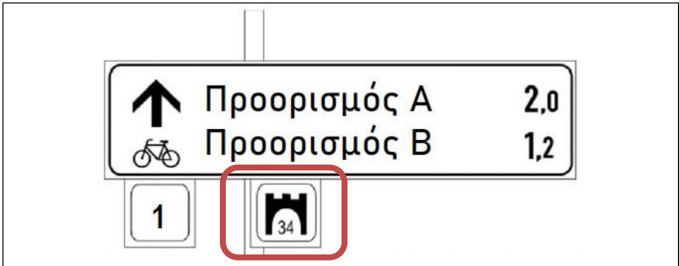
Εικόνα 13: Τοποθέτηση πρόσθετης πινακίδας σε πληροφοριακή σήμανση ποδηλάτου (Πηγή: ΟΜΟΕ-13).
